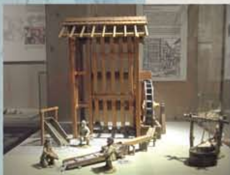
Modell eines Pochwerks nach Agricola im Goldbergbaumuseum Goldkronach (Fertigung: Reinhard Günther, Leisau).
